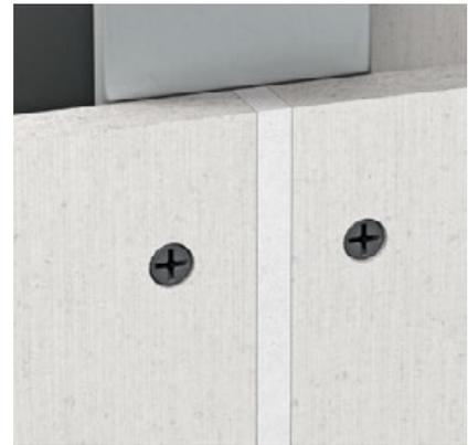
fermacell Spachtelfuge - Fugenbreite:  $\frac{1}{2} \times$  Plattendicke + max. 3 mm
